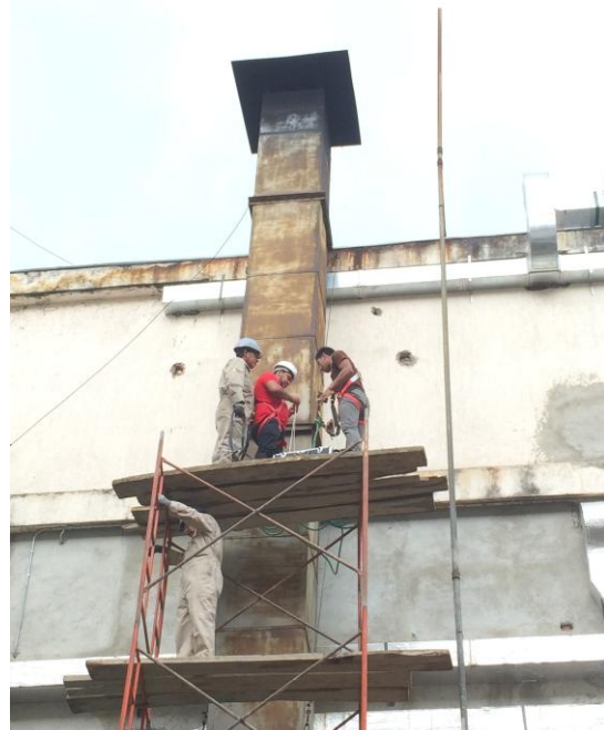
Figura 34. Medición y registro de gases contaminantes del Hospital Isidro Ayora.
