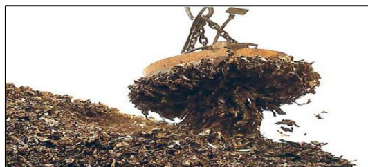
Figura 2. Grúa recogiendo materiales magnéticos
