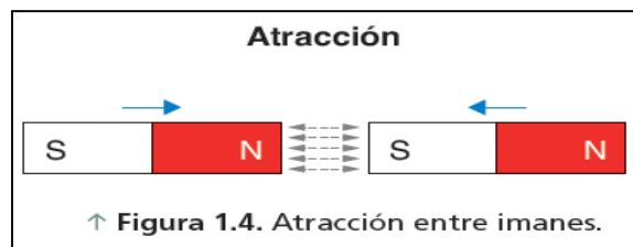
Figura 8. Indica la atracción de los imanes, tomado del libro maquinas eléctricas de Juan Carlos Martín
