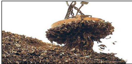
Figura 2. Grúa recogiendo materiales magnéticos
