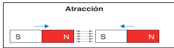
Figura 10. Cuando se acercan polos diferentes, se atraen, tomado del libro maquinas eléctricas de Juan Carlos Martín
