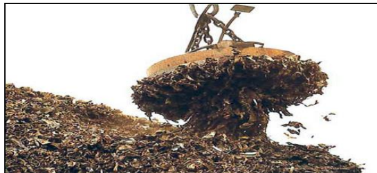
Figura 23. Grúa recogiendo materiales magnéticos
