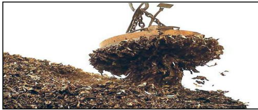
Figura 2. Grúa recogiendo materiales magnéticos 4
