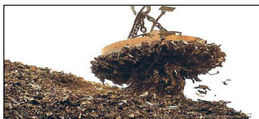
Figura 2. Grúa recogiendo materiales magnéticos
