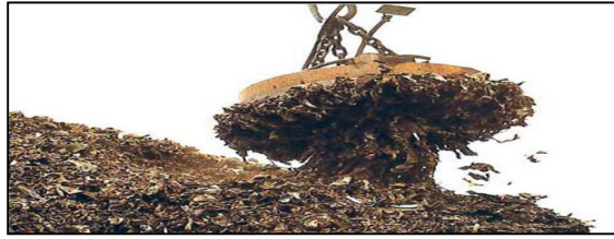
Figura 2. Grúa recogiendo materiales magnéticos 19
