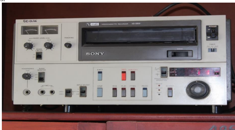
Foto 3.- El equipo reproductor de Umatic que cuenta la Carrera de Comunicación Social se encuentra dañado por el polvo y el hongo que contiene. Actualmente ya no se vende repuestos de para esta máquina.
