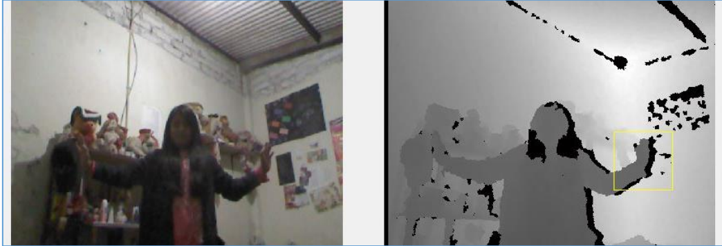
Figura 61. Seguimiento de la mano derecha. Imagen de la cámara de color (izq.). Imagen del sensor de profundidad (der.)
