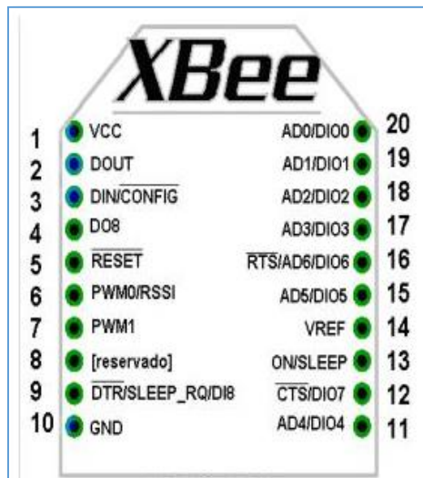
Figura. 30: Descripción de los Pines del Xbee S2B
