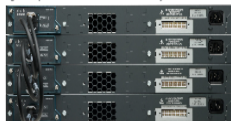
Figura 2. Apilamiento FlexStack en switches 2960-S y 2960-SF
