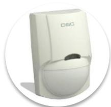
**Detector de Rayos Infrarrojos Pasivos (PIR):** detectan y miden la energía infrarroja, están en la capacidad de detectar emisiones entre 8 y 12 micrómetros para ello utilizan un fotodetector que convierte estas longitudes de onda de luz en una corriente eléctrica. la alarma se activa cuando existen cambios rápidos o grandes de energía infrarroja emitida.
