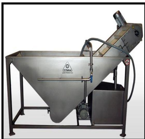
Lavadora de frutas de inmersión y aspersion. Se utiliza para lavar frutas y hortalizas de hasta 10 cm. Utilizando para ello un tanque de inmersión con turbulencia y una ducha de aspersion plana para terminar el lavado superficial del producto.
