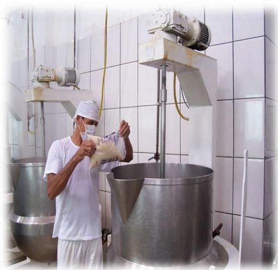
Llamado como tacho dulcero, es equipado con una fuente de calor a gas con regulador de temperatura con capacidad de 22 kg por cada carga de producción, aspas giratorias accionadas por motor con su control y de accionamiento
