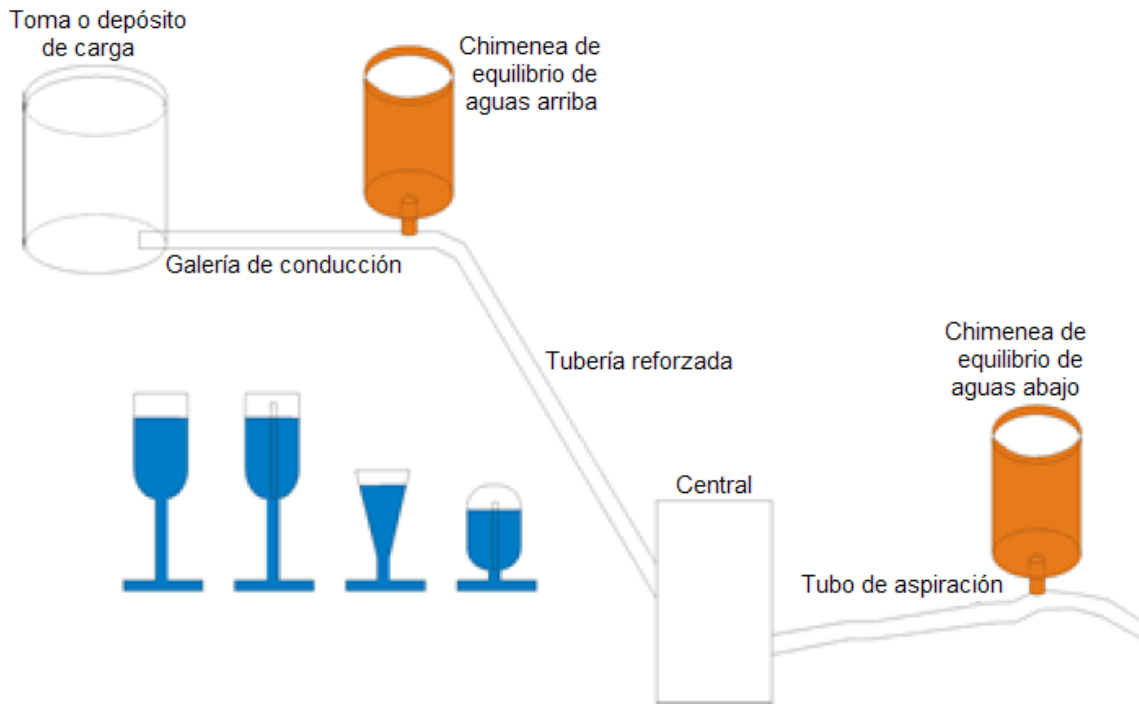
Figura 2.14. Esquema de la ubicación de las Chimeneas de Equilibrio
