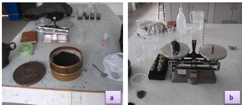
Figura 13: Tamizado de suelo (a); pesado del suelo (b) "Laboratorio de sanidad vegetal" Loja, junio 2015.
