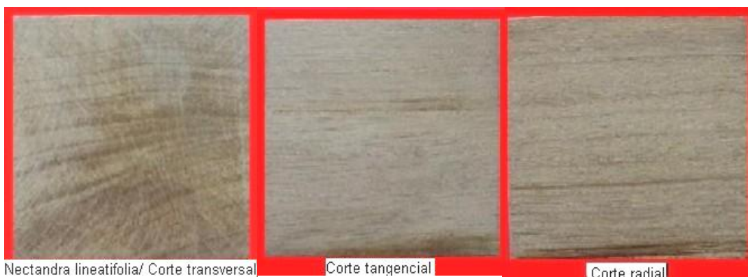
Figura 46. Planos de corte macroscópico en madera de Nectandra lineatifolia (Ruiz & Pav.) Mez
