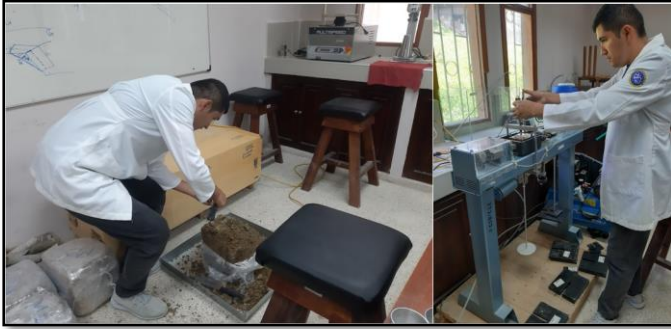
Figura 48: Tallado y colocación de la muestra en la caja de corte
