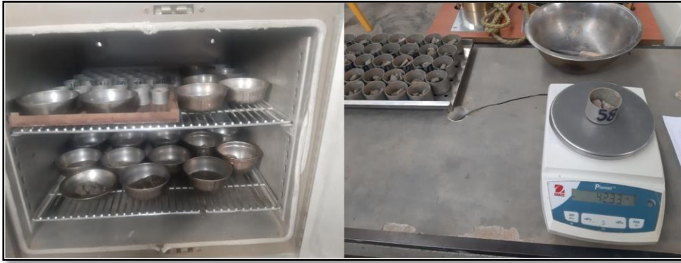
Figura 39: Ensayo para determinar los contenidos de humedad.
