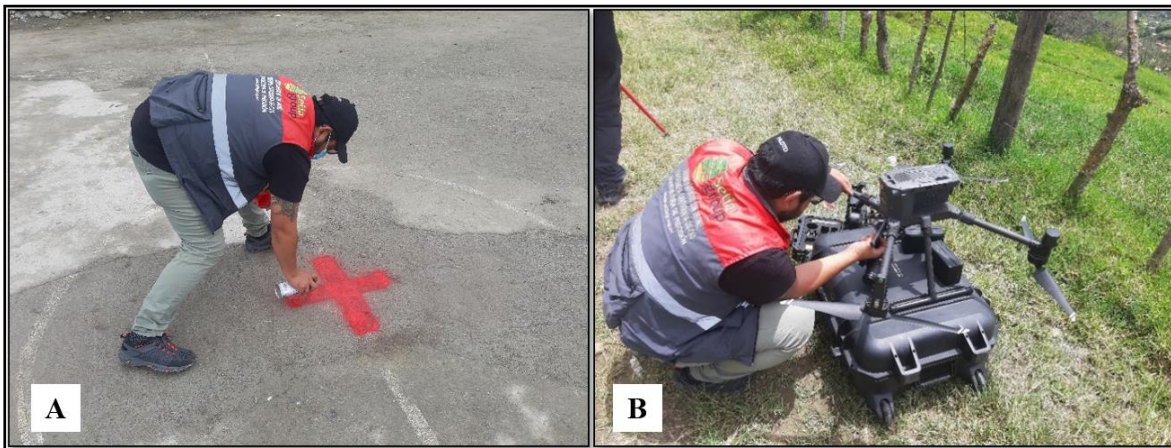
Figura 21: A) ubicación de puntos de control; B) Vehículo aéreo tripulado (UAV dron modelo ZENMUNSEPI)
