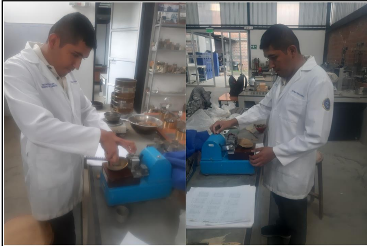
Figura 41: Determinación del límite líquido a través del equipo de Casagrande.
