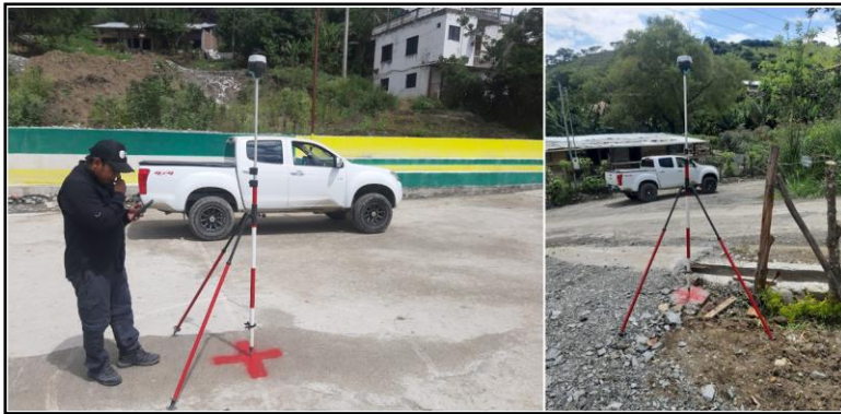
Figura 24: Levantamiento de puntos de control GCP
