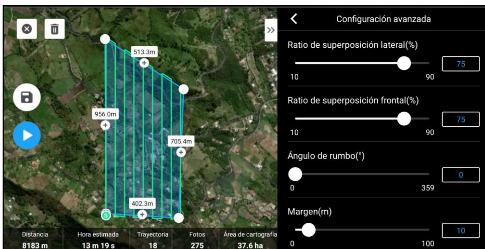
Figura 28: Superposición lateral y frontal del equipo topográfico.
