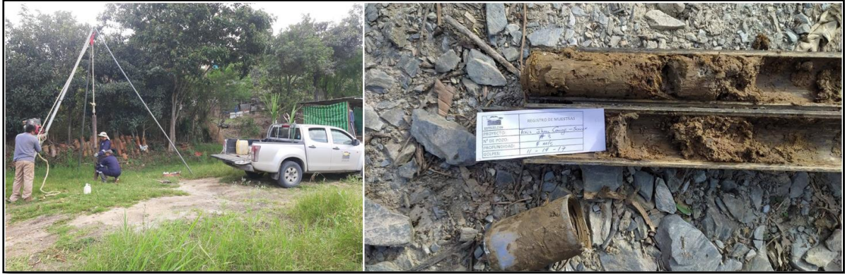
Figura 38: Recolección de muestras inalteradas mediante ensayo SPT.
