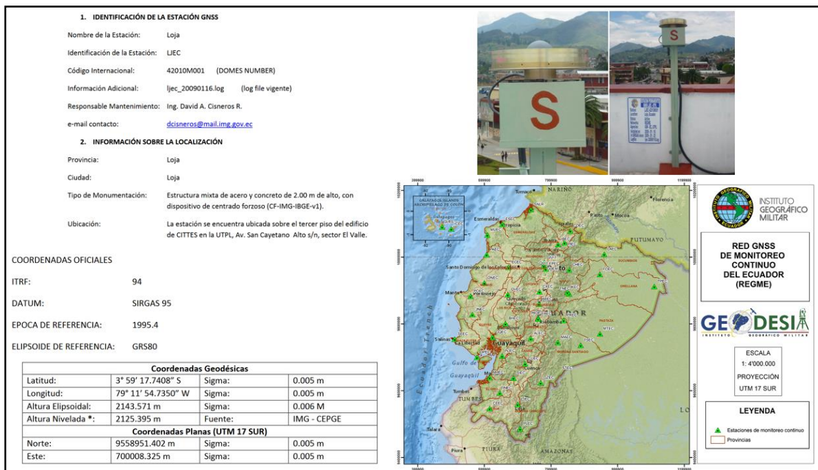
Figura 23: Ubicación de la estación GNSS de monitoreo continuo LJEC.
