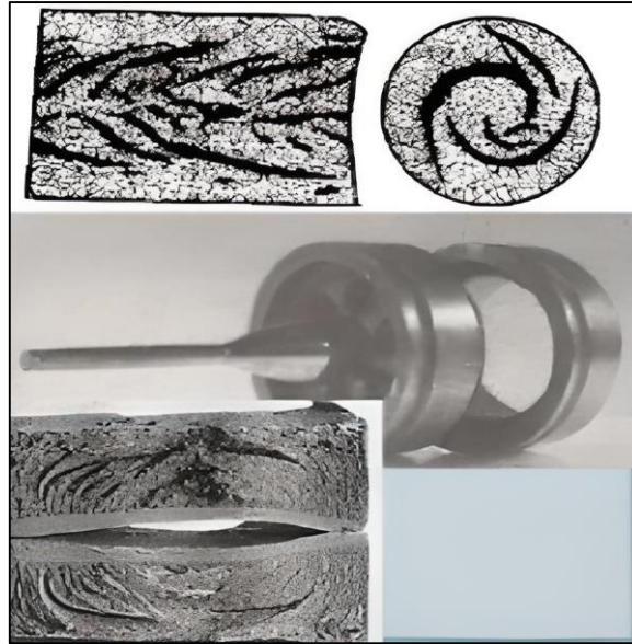
Figura 23. Grietas y laminaciones al salir de la matriz
