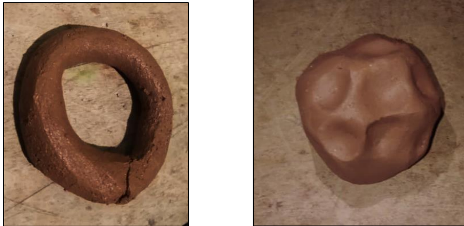
Figura 116. Prueba de mezcla de arcilla para trabajar con el sistema de extrusión.
