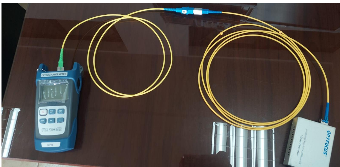
Figura 38 Medir la potencia con el atenuador óptico
