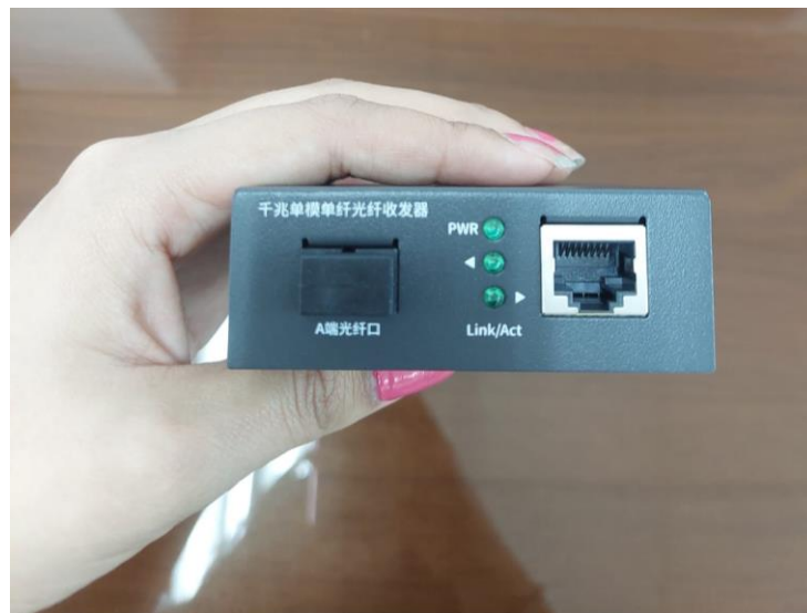
Figura 58 Convertidor de medios con tecnología WDM
