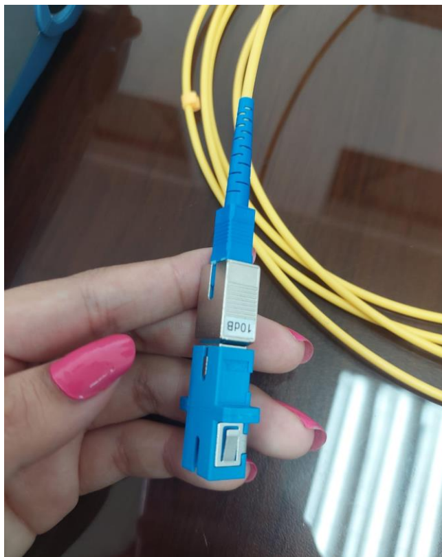
Figura 37 Colocar adaptador SC/UPC - SC/UPC
