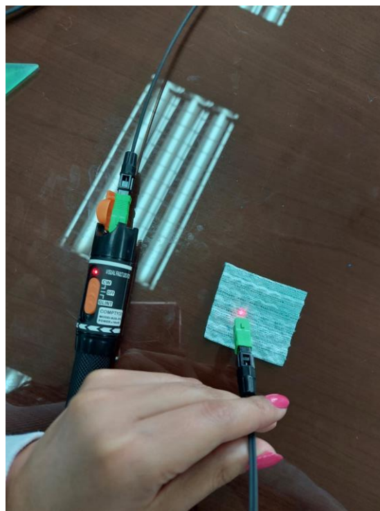
Figura 33 Pruebas con VFL desde el otro extremo del conector SC/APC
