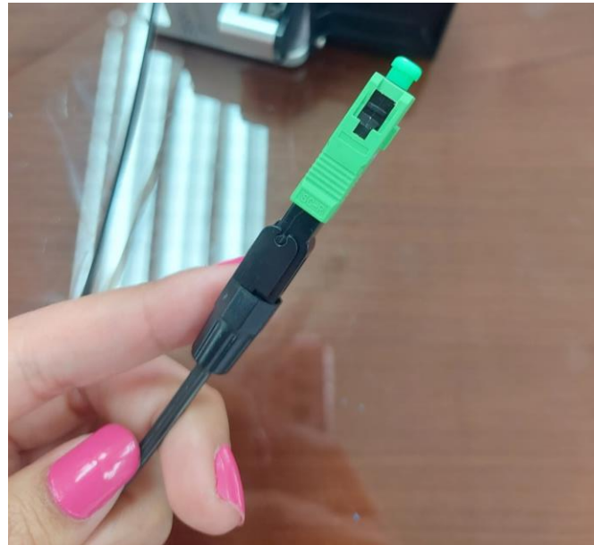
Figura 13 Colocar el cuerpo externo del conector
