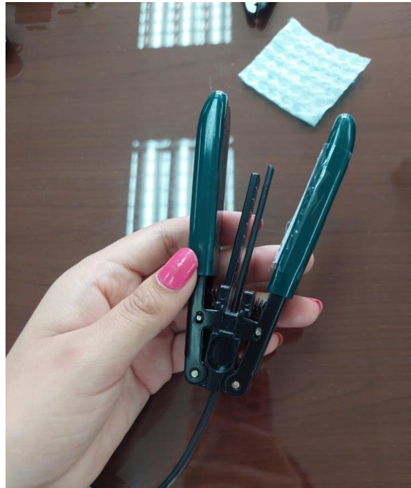
Figura 4 Retirar la cubierta externa del cable drop con la peladora tipo drop
