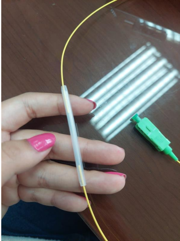
Figura 6 Cubrir la fusión con el tubillo termocontraíble
