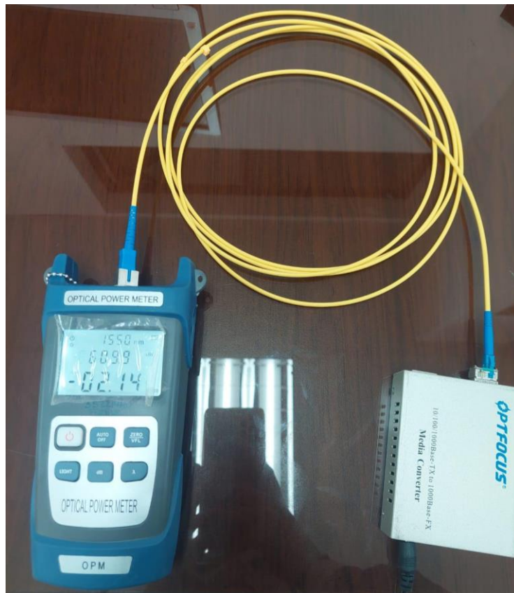
Figura 8 Potencia inicial con el transceiver PT7820-41-2W
