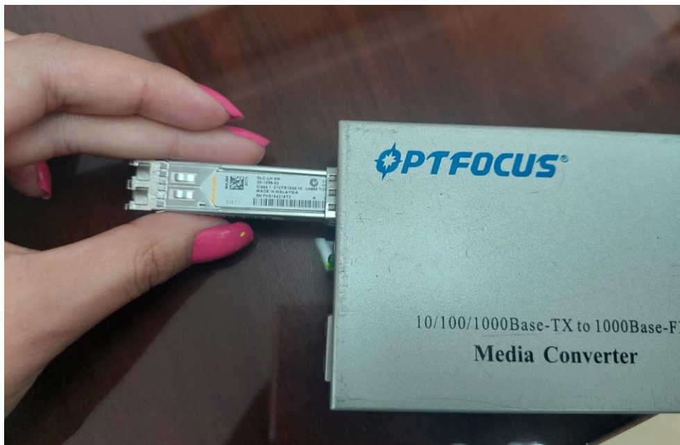
Figura 33 Colocar el transceiver SFP en el convertidor de medios
