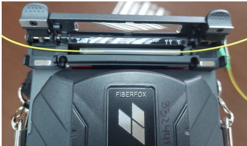
Figura 7 Introducir en el horno de fusión
