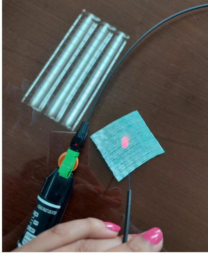
Figura 14 Pruebas de verificación con el VFL
