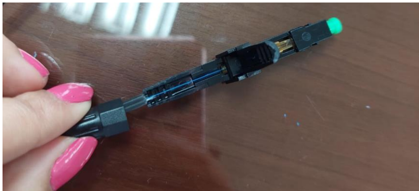
Figura 11 Colocar la fibra en la guía de inserción hasta que llegue a tope
