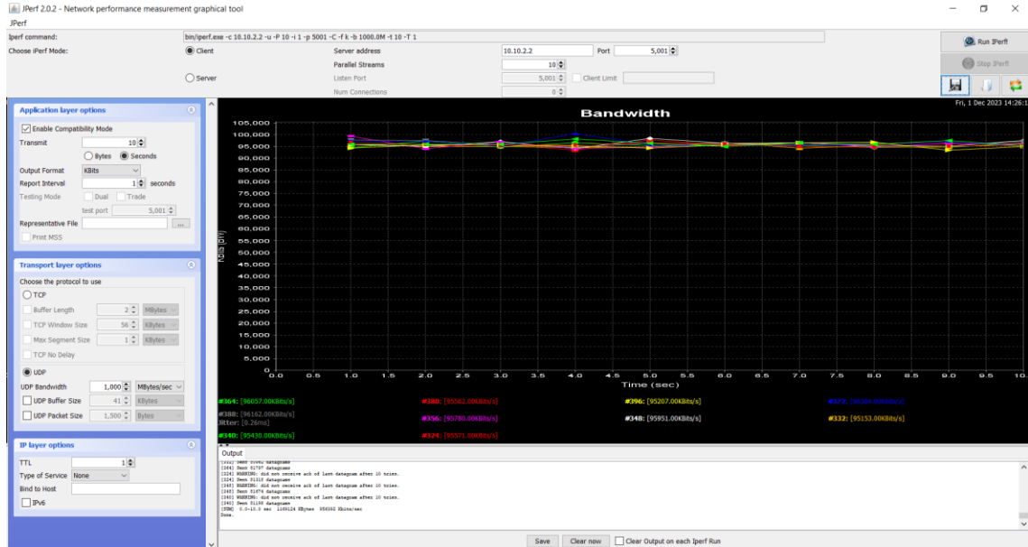
Figura 31 Cliente: 10 parallel streams con ancho de banda de 1000 MBytes/sec
