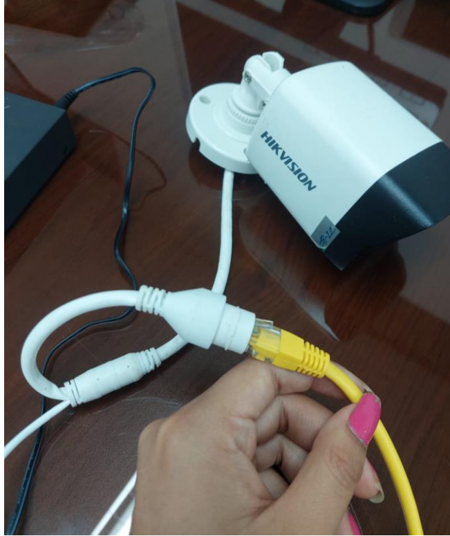
Figura 73 Conexión del patch UTP a la cámara IP
