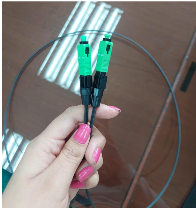
Figura 31 Armado de un conector mecánico en ambos extremos de la fibra óptica
