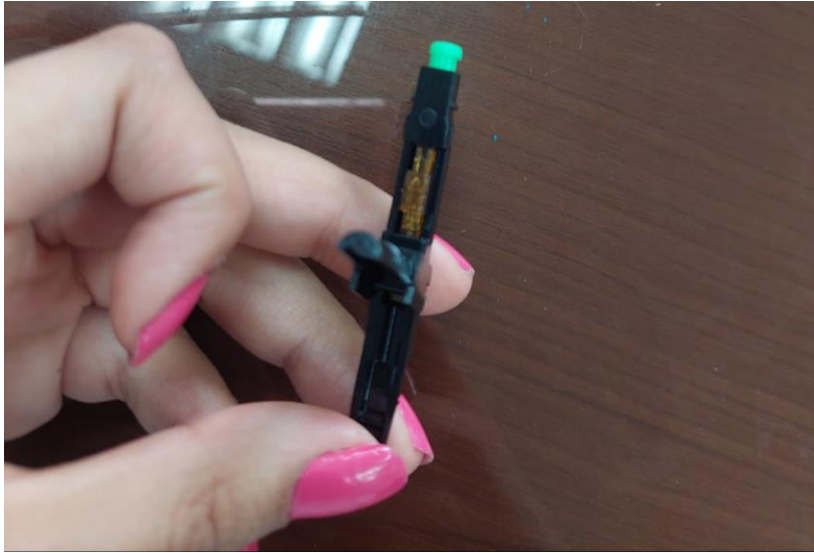
Figura 10 Abrir la cubierta del conector
