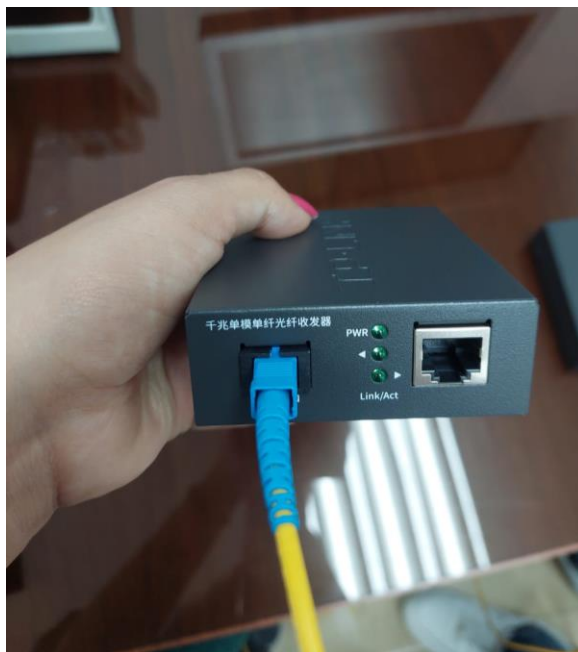
Figura 59 Conexión del patch cord en el puerto de fibra del convertidor de medios
