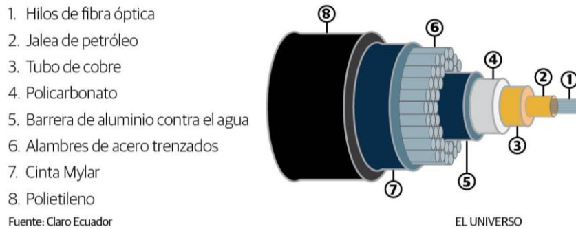
Figura 18 Partes del cable submarino
