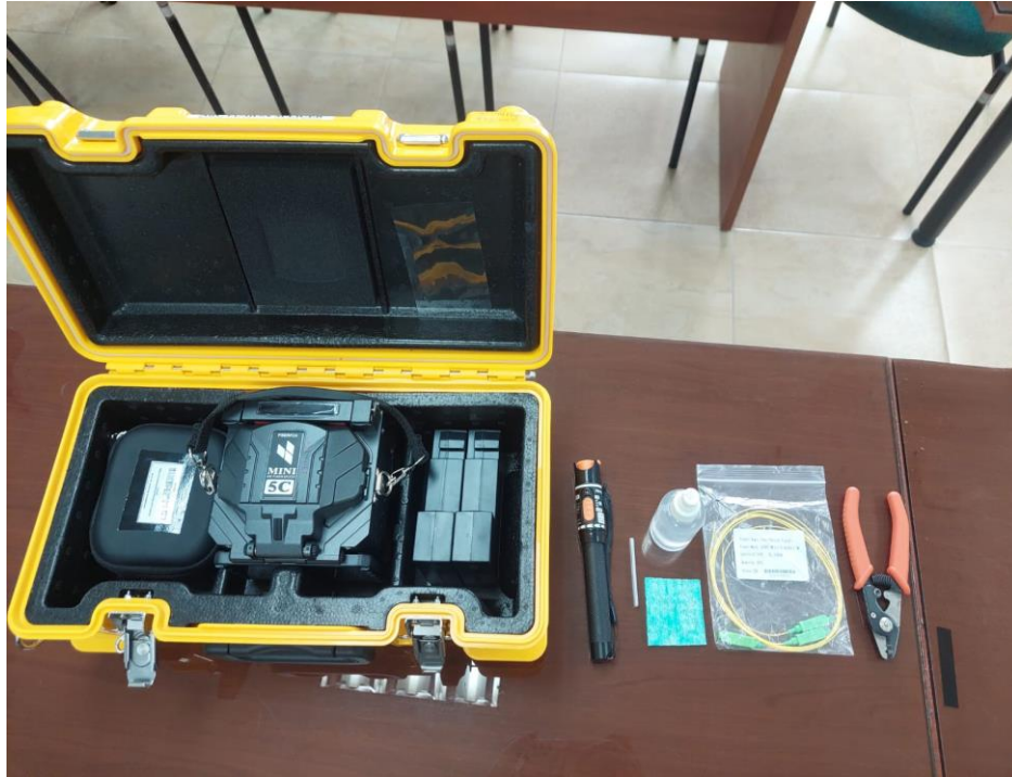
Figura 1 Herramientas y equipos para fusionar fibra óptica
