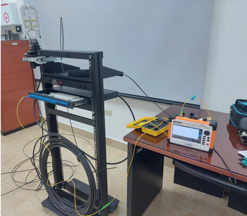
Figura 13 Conexión desde el OTDR al ODF rackeable
