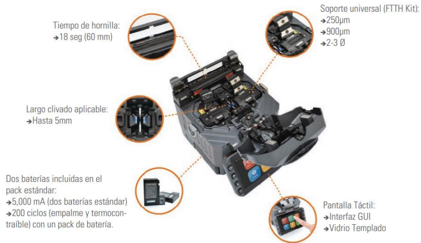
Figura 5 Características generales de la fusionadora fiberfox mini 5c
