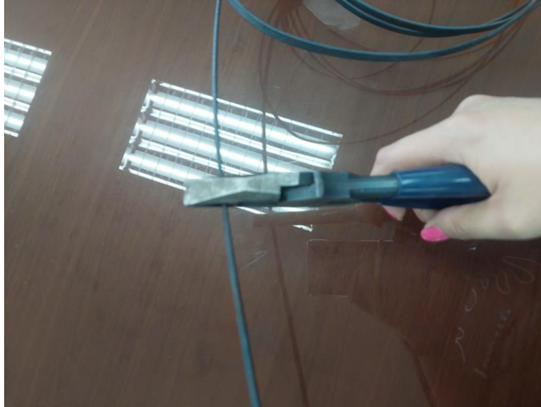
Figura 2 Cortar con el alicate la longitud deseada
