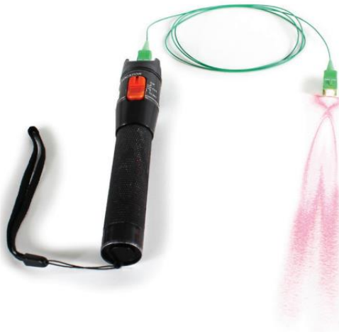
Figura 29 Verificación con paso de luz
