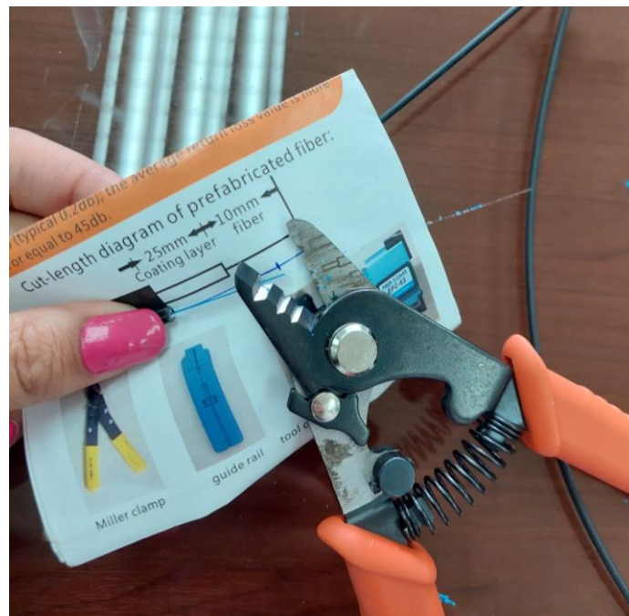
Figura 7 Retirar el recubrimiento del hilo de la fibra con la peladora
