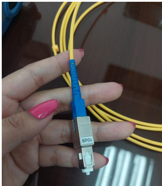
Figura 36 Colocar atenuador óptico SC/UPC
