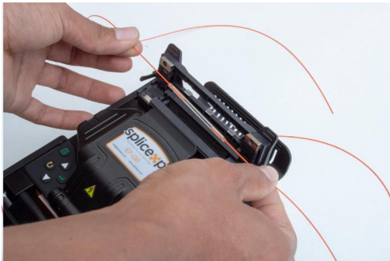
Figura 4 Empalme por fusión
