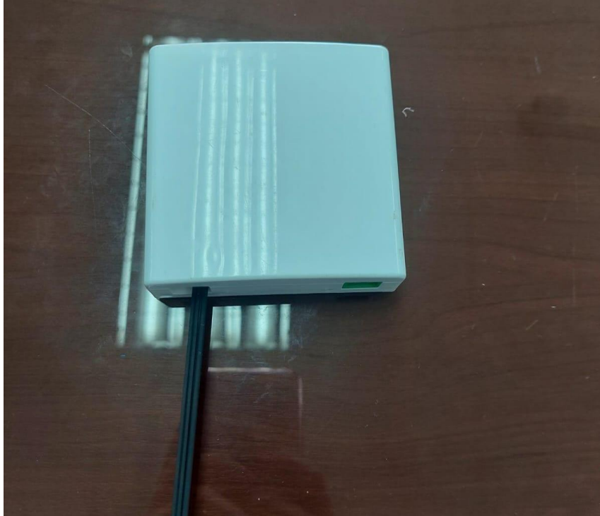
Figura 5 Armado de una roseta
