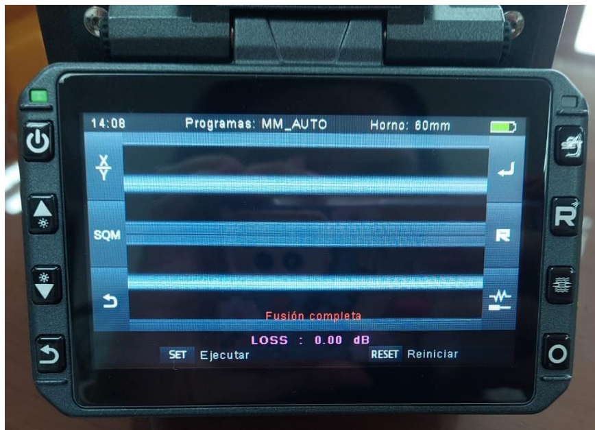
Figura 2 Pérdidas por fusión 0.00 dB
