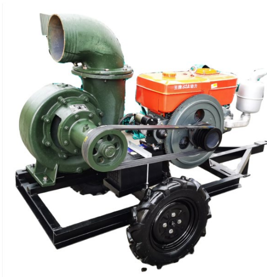
Figura 36. Adaptación de la bomba y el motor mediante poleas
