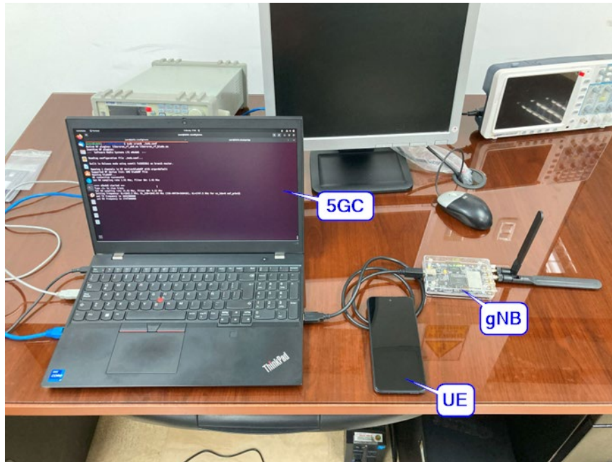
Figura 32. Entorno empleado para el despliegue de 5G SA con BladeRF 2.0 micro Ax9 Fuente: Elaboración propia
