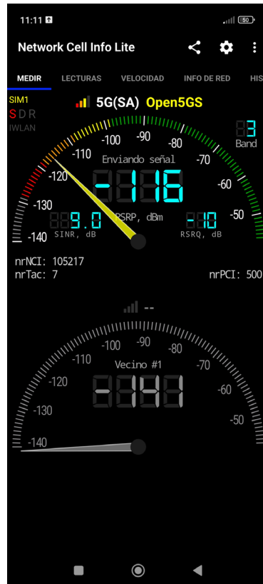
Figura 55. Potencias promedio recibida a 8 metros de distancia de la gNB Fuente: Elaboración propia
