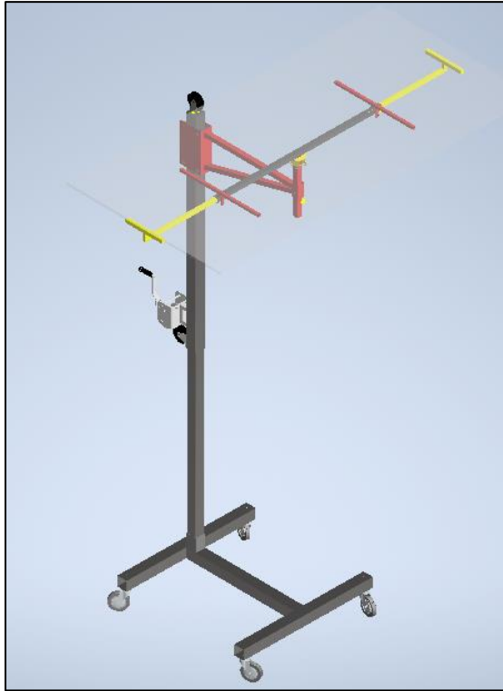
Figura 58. Sistema de elevación de placas de gypsum.
