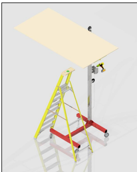
Figura 88. Plancha de gypsum colocada sobre la plataforma en su altura máxima.
