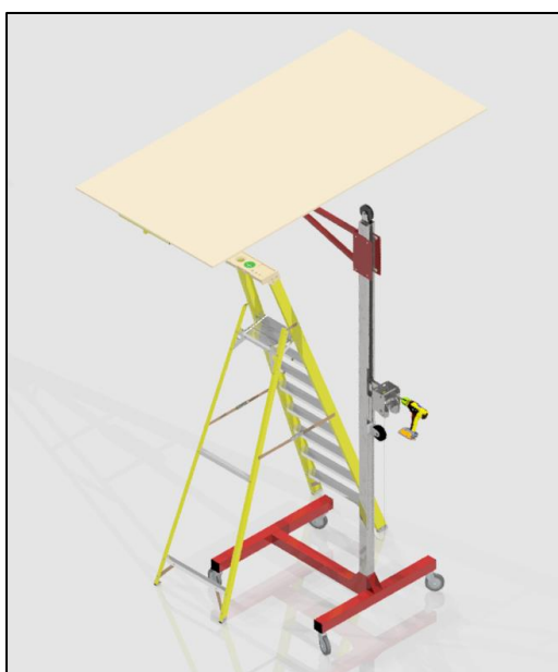
Figura 89. Vista posterior de la plancha de gypsum colocada sobre la plataforma en su altura máxima.
