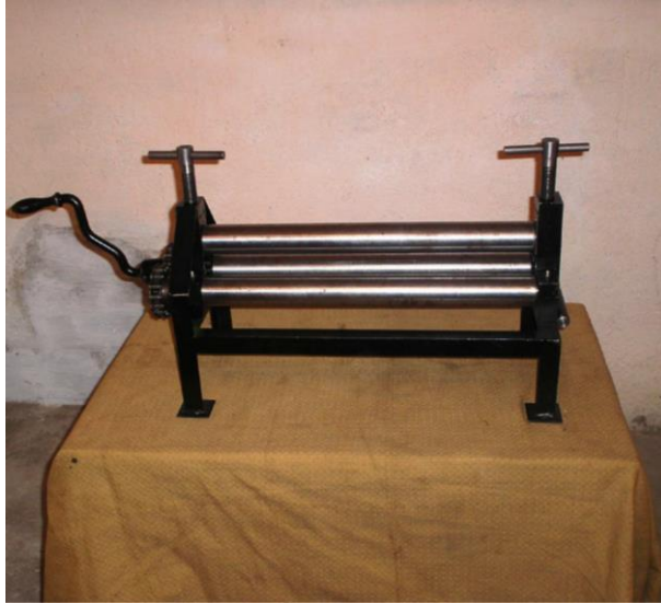
Figura 6 Roladora manual de 500 mm de longitud útil
