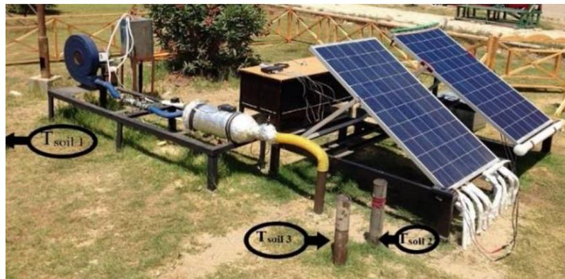
**Figura 18.** Sistema de enfriamiento de paneles fotovoltaicos mediante intercambiador de calor.
