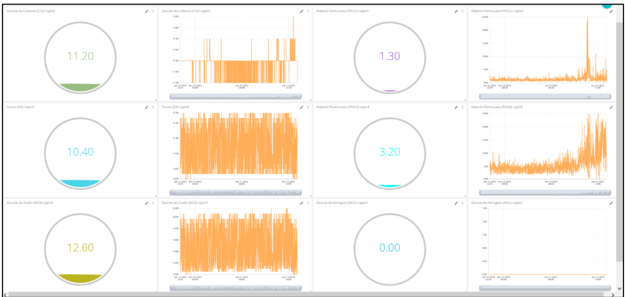
Figura 64. Tablero Web que presenta los valores de los medidores de calidad de aire.
