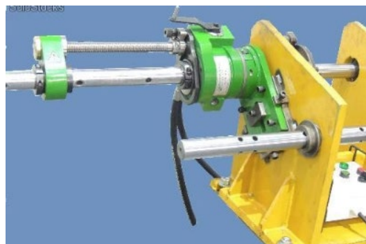
Figura 4. Mandrinadora hidráulica, Farmin S.A.C(2020).
