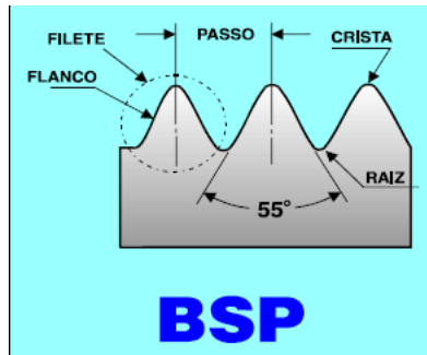
Figura 18. Roscas para unión de tuberías (Plata, 2020)
