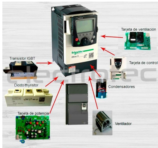
Figura 29. Partes de un variador de frecuencia (Electrotec, 2020)
