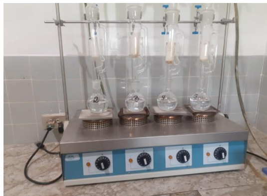
Anexo 26. Equipo realizando la extracción de grasa.
