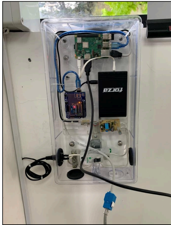
Figura 55. Sismografo digital instalado en el I2TEC de la Univeridad Nacional de Loja
