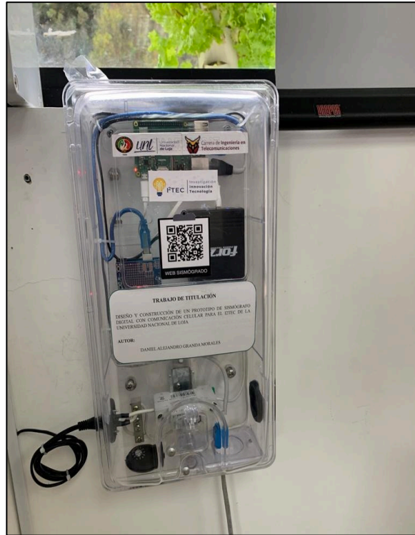
Figura 54. Sismografo digital instalado en el I2TEC de la Univeridad Nacional de Loja
