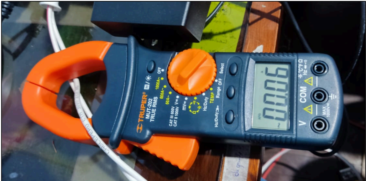
Figura 23. Medición de consumo de corriente de la estación sísmica
