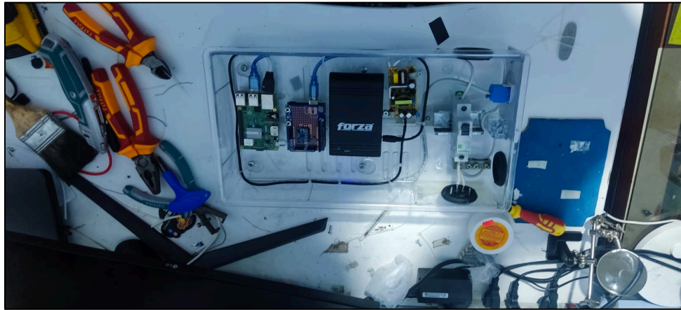
Figura 51. Construcción de estación sísmica
