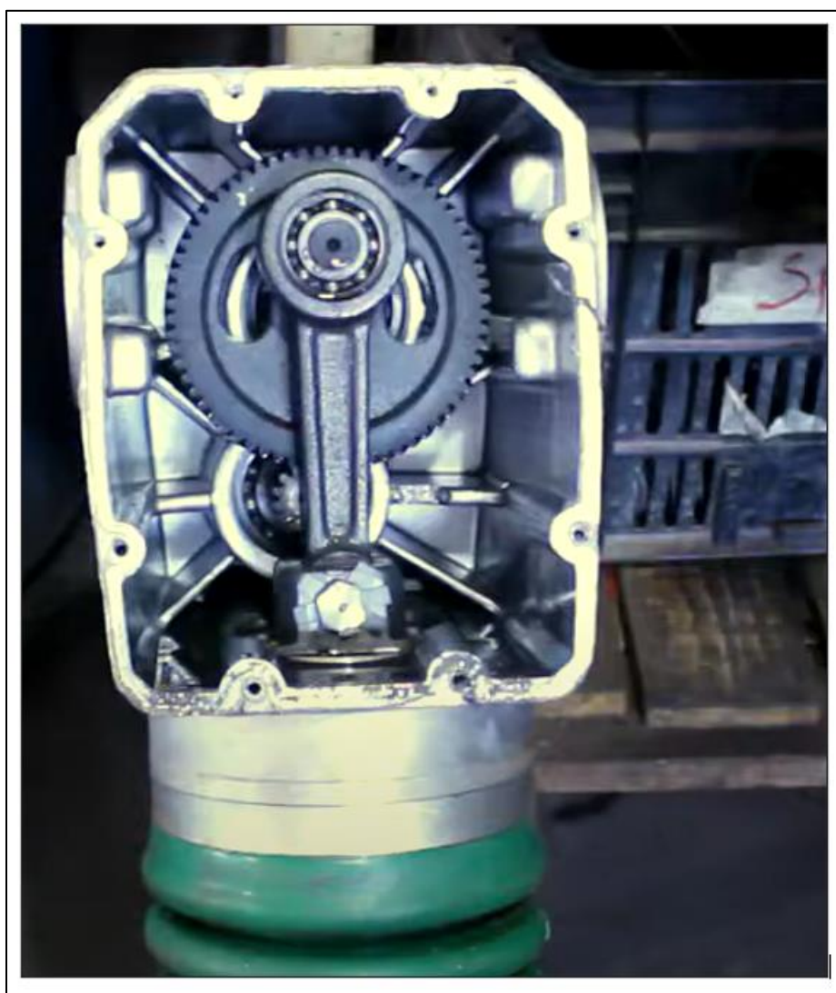
Figura 24. Transmisión de engranajes y leva de vibro-apisonadores.
