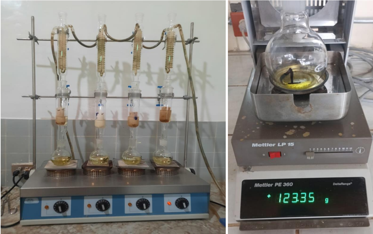
Figura 8. Extracción de grasa a través del método Soxhlet.
