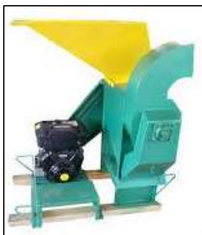
Figura 3. Desgranadora con motor a combustión
