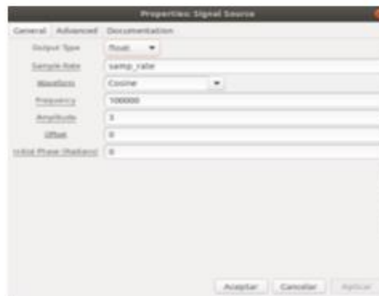
Fig 11. Configuración del bloque con la señal modulante.
