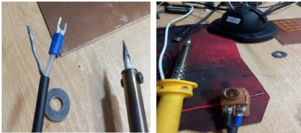
Fig. 7: Colocación de conectores adecuados para evitar pérdidas desde la antena al SDR.
