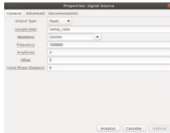
Fig 10. Configuración del bloque Signal Source y su frecuencia.
