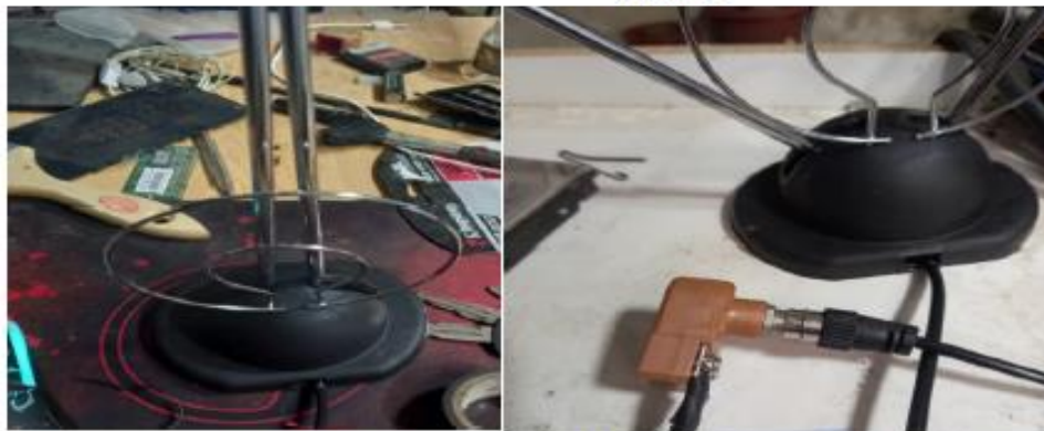
Fig. 8: Antena a utilizar acoplada con el adaptador de impedancias.
