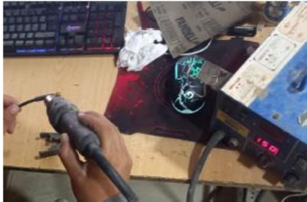
Fig. 6: Colocación de cinta termo retráctil para evitar daños a futuro.
