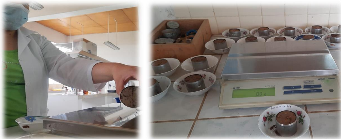
Anexo 3. Determinación de la densidad aparente en el Laboratorio de Suelos, Aguas y Bromatología de la Universidad Nacional de Loja.
