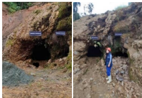
Figura 29. Bocaminas de las Galerías Exploratorias (G1 Y G2) de la Concesión minera "El Venado"
