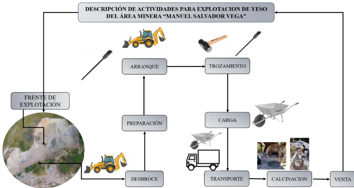
Figura 41. Esquema de las Actividades Mineras Actuales de Explotación de Mineral de Yeso en el Área Minera “Manuel Salvador Vega”
