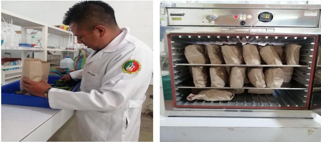
Anexo 13. Picado y pesado de la muestra de las tres especies de pastos para ser llevada a la estufa.
