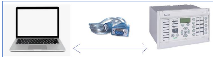
Figura 36. Comunicación serial USD a RS232
