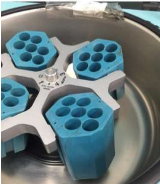
Centrifuga sin la limpieza adecuada.
