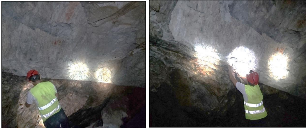
Figura 40: falla de segundo orden que atraviesa las galerías del bloque de explotación Ubicación: a 128 m del pozo en el 2do nivel al lado este. Fecha: 05/2021
