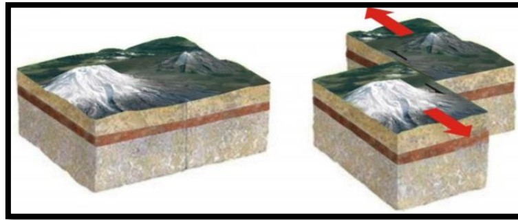
Figura 6: falla de desgarre
