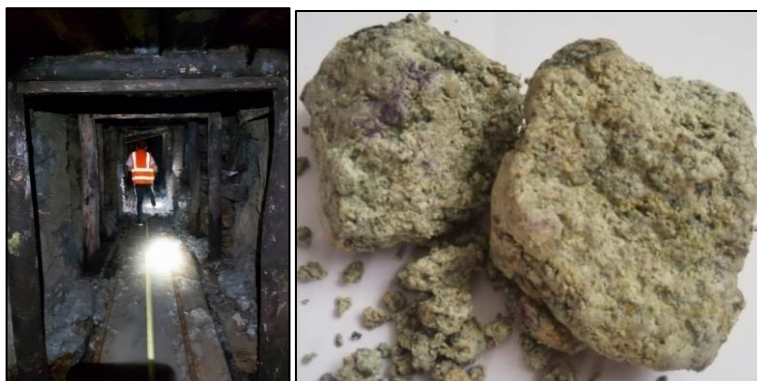
Figura 37: material disgregado presente en la fortificación Ubicación: a 72.7m del pozo en el 3er nivel Fecha: 05/2021 Fuente: el autor
