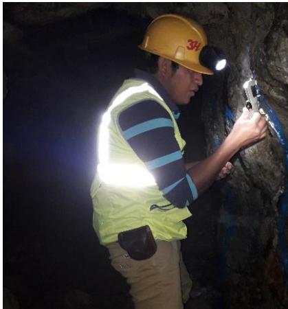
Medición de las Discontinuidades
