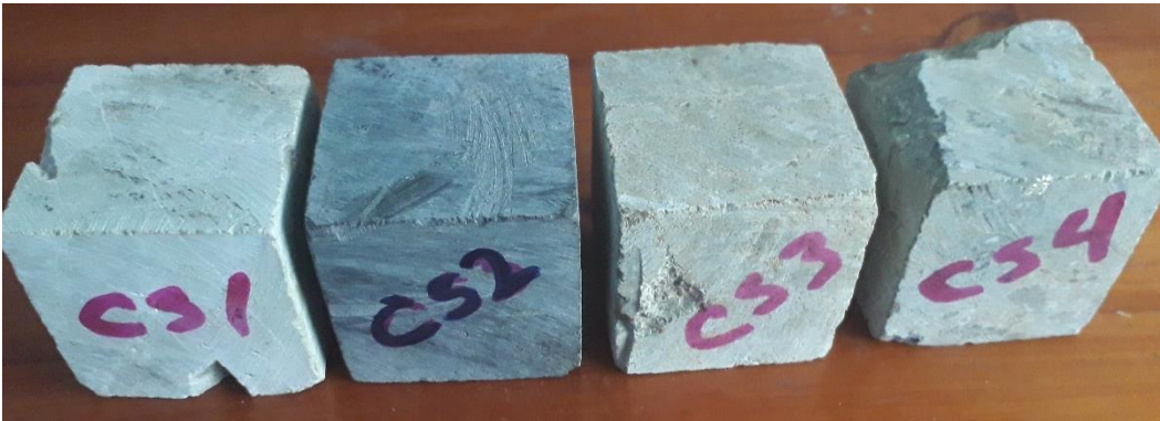
Cubos de rocas para el ensayo de compresión simple
