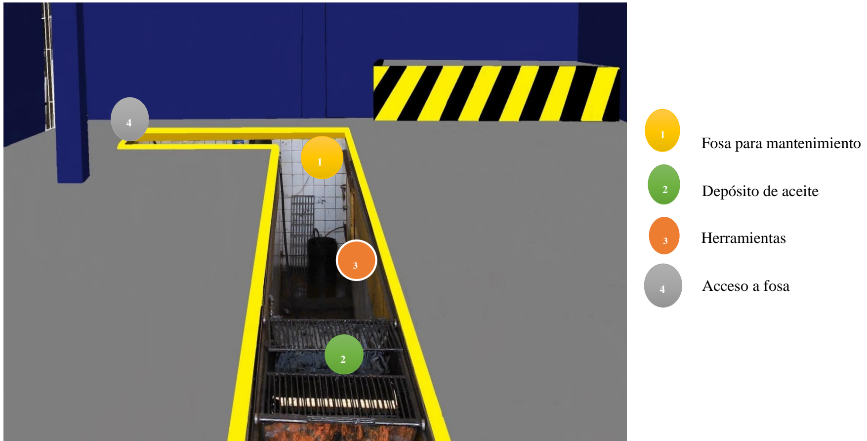
Imagen 17. Diseño de fosa para mantenimiento de la flota vehicular del GAD Sozoranga
