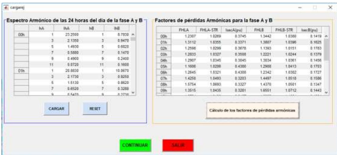
Figura 43. Espectro armónico y cálculo de los factores de pérdidas armónicas para la fase A y B del transformador de 15 kVA.
