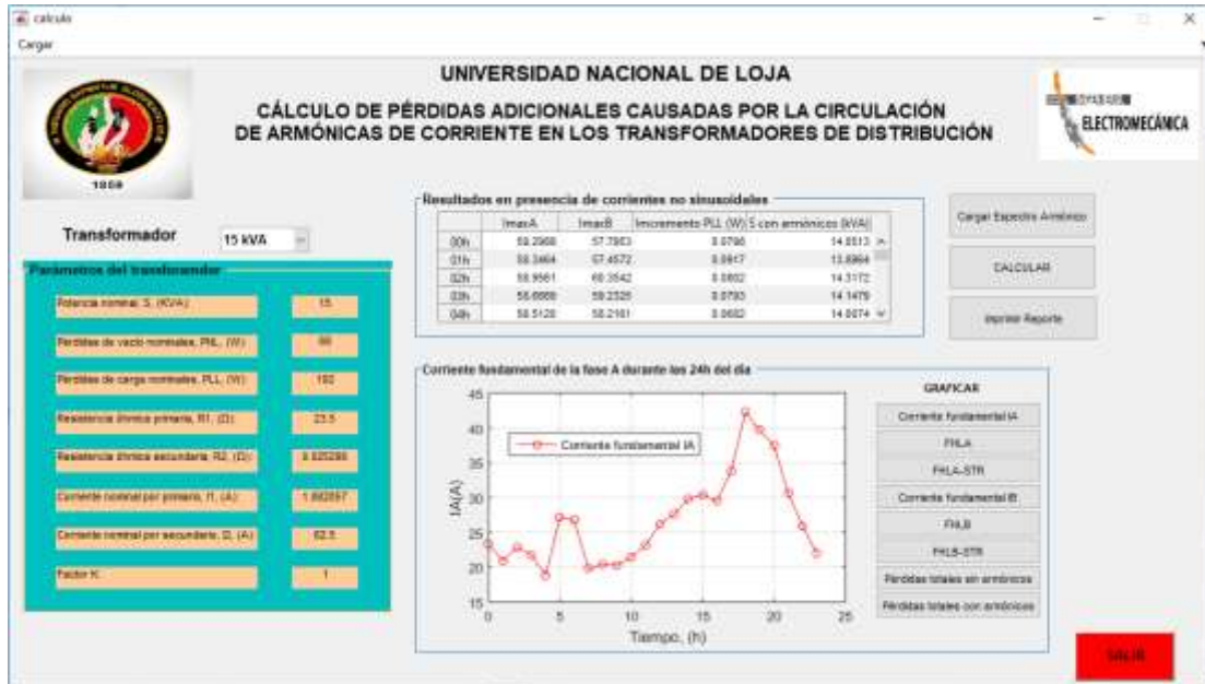
Figura 44. Cálculos de las pérdidas adicionales causados por la circulación de armónicas de corriente en un transformador de 15 kVA usando la GUI.
