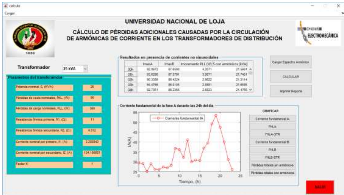
Figura 48. Cálculos de las pérdidas adicionales causados por la circulación de armónicas de corriente en un transformador de 25 kVA usando la GUI.
