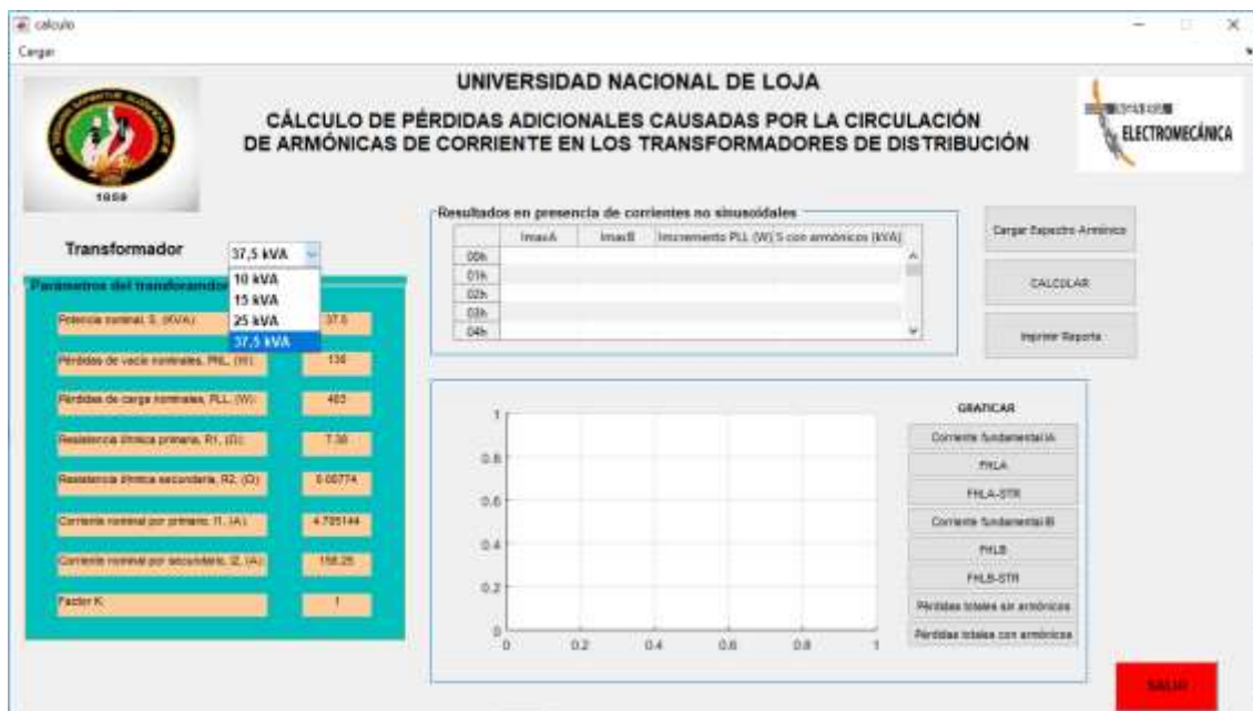
Figura 49. Parámetros del transformador de 37,5 kVA.
