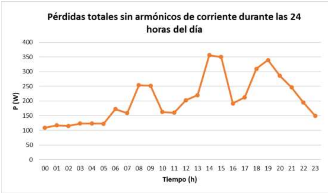
Gráfica 5. Pérdidas totales sin armónicos en el transformador de 10 kVA durante las 24 horas del día.
