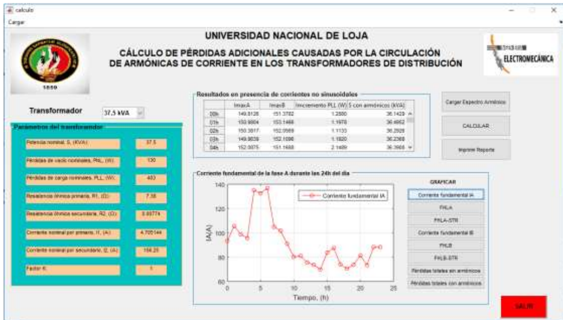
Figura 52. Cálculos de las pérdidas adicionales causados por la circulación de armónicas de corriente en un transformador de 37,5 kVA usando la GUI.
