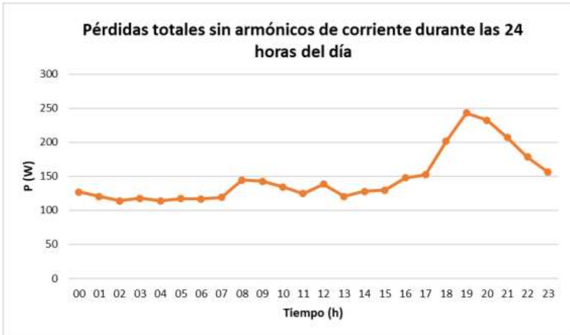
Gráfica 17. Pérdidas totales sin armónicos en el transformador de 25 kVA durante las 24 horas del día.
