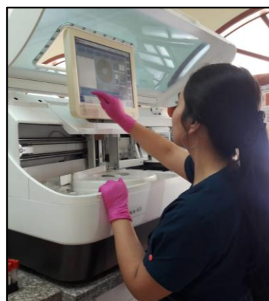
Colocación de muestras en copillas, e ingreso de cada paciente en el equipo
