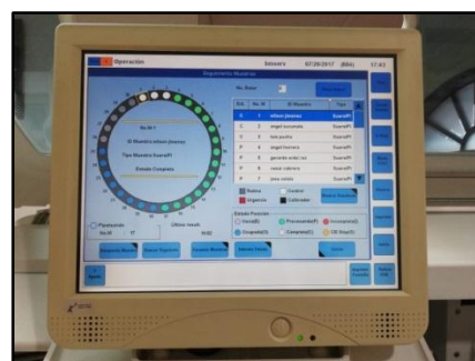
Muestra pipeteada (verde), muestra ingresada para ser pipeteada (azul), resultado (blanco).
