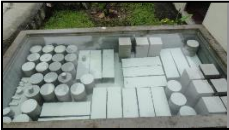
Figura 20. Bloques elaborados con agregados de relaves mineros
