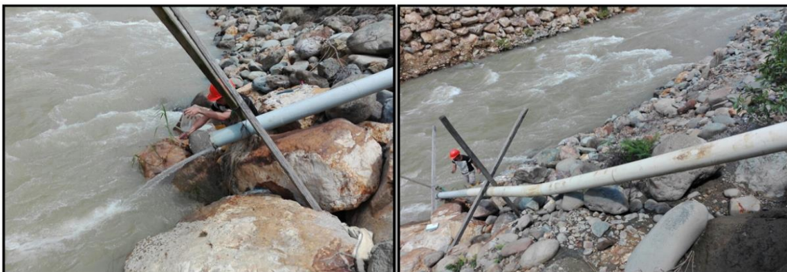
Fotografía 9. Medición de Caudal a través del Método Volumétrico
