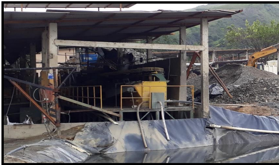
Fotografía 28. Tanque receptor con Bomba/Relave 1-Descarga Principal.
