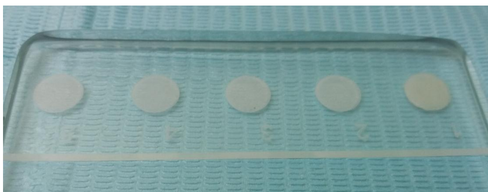
Figura N° 3: Discos de resina cubiertos por una placa de vidrio.
