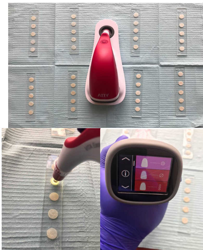
Colocación del espectrofotómetro, para la toma del color final de las muestras (Fuente: Alejandro Arza)
