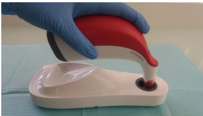
Colocación del espectrofotómetro (Easy Shade) para calibrarlo (Fuente: Alejandro Arza)
