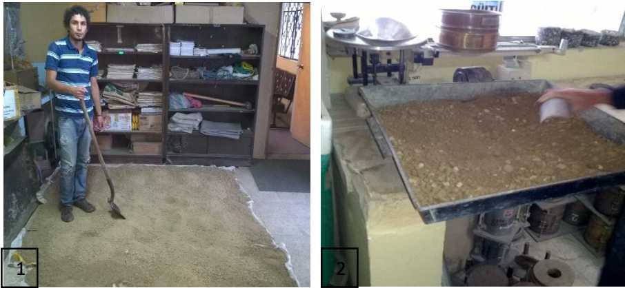
Figura 1 y 2. Preparación de la muestra de suelo y dosificación de la misma
