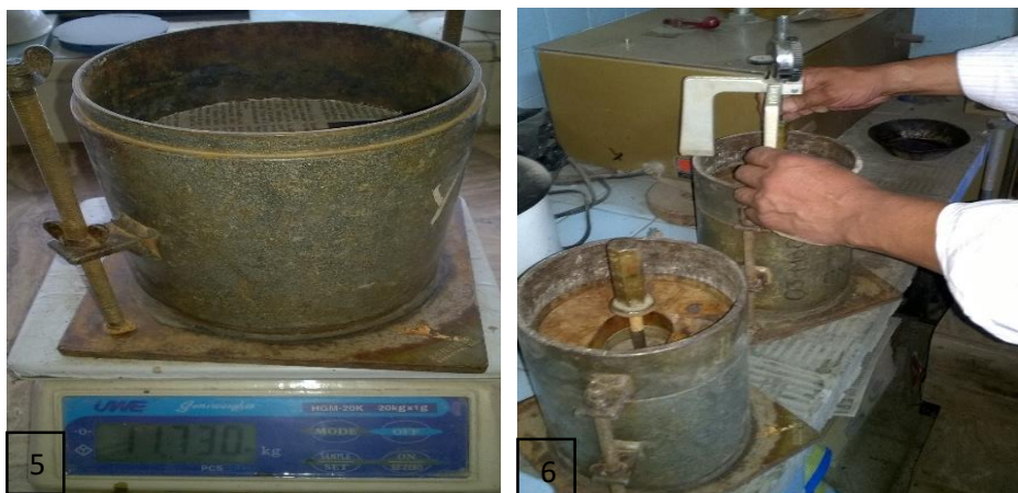
Figura 5 y 6. Toma de los pesos correspondientes a cada muestra dosificada y compactada
