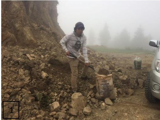
Foto1 y 2. Limpieza del lugar de extracción del suelo y recolección de muestra para laboratorio
