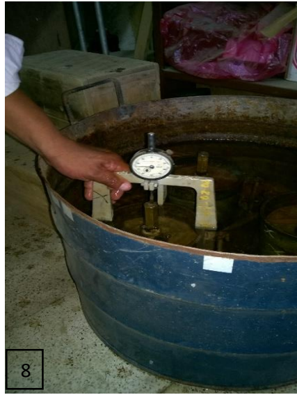
Figura 7 y 8. Curado de las muestras estabilizadas y medicion del esponjamiento
