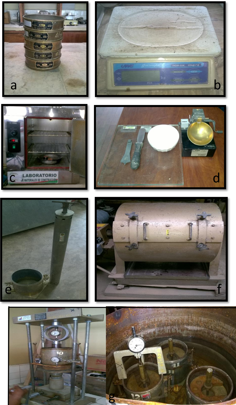
Figura 16. Equipo utilizado en laboratorio: a) Juego de tamices. b) Balanza de precisión. c) Estufa. d) Ensayo para límites de Atterberg. e) Ensayo Próctor estándar. f) Máquina de los ángeles. g) ensayo para CBR.
