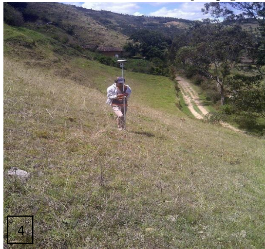
Foto 4. Levantamiento de la franja topográfica
