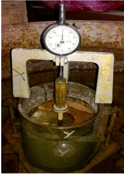
Figura 7 y 8. Curado de las muestras estabilizadas y medicion del esponjamiento
