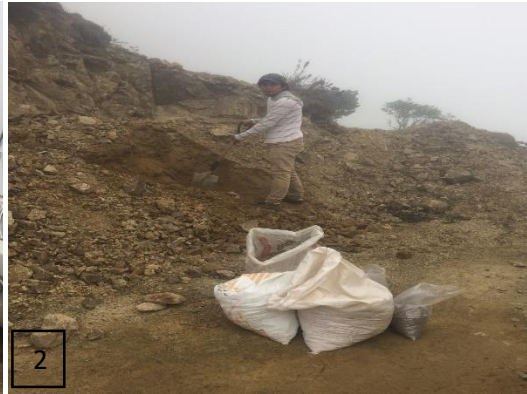
Foto1 y 2. Limpieza del lugar de extracción del suelo y recolección de muestra para laboratorio
