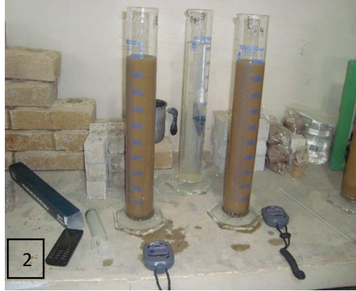
Foto 1 y2. Granulometría mediante hidrómetro
