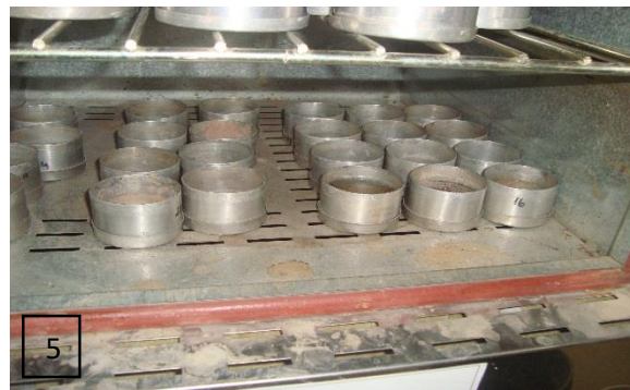
Foto 3,4 y 5. Granulometría por lavado a través del tamiz y secado al horno.
