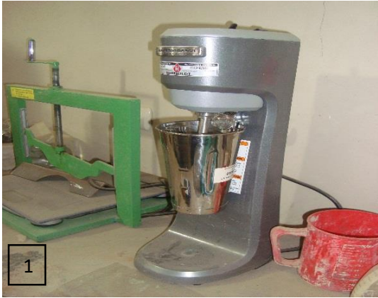
Foto 1 y2. Granulometría mediante hidrómetro
