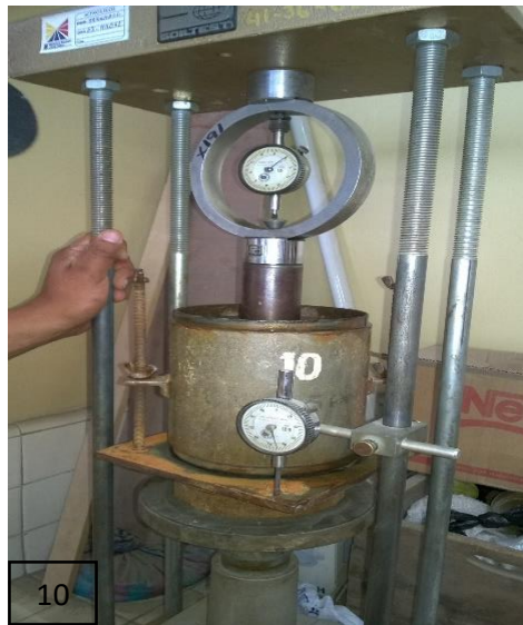
Figuras 9 y 10. Ensayo de resistencia a la fuerza cortante (CBR).
