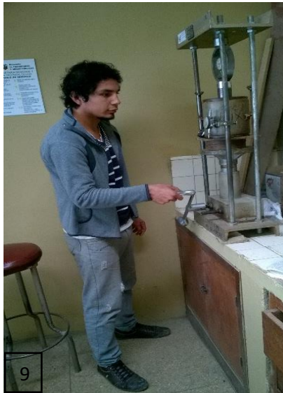
Figuras 9 y 10. Ensayo de resistencia a la fuerza cortante (CBR).
