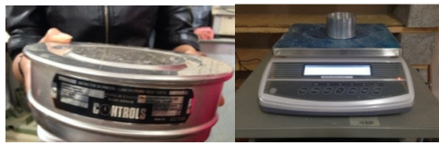
Figura 34. Cernido y pesando el suelo
