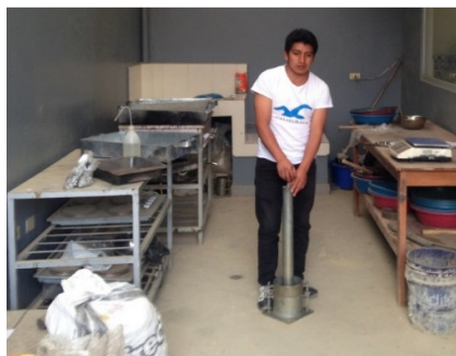
Figura 44. Compactación del material
