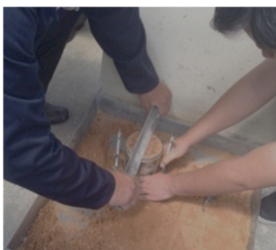
Figura 45. Enrazando el molde
