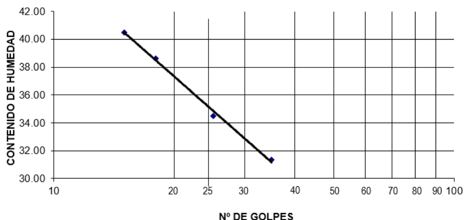
Figura 39. Diagrama límite líquido
