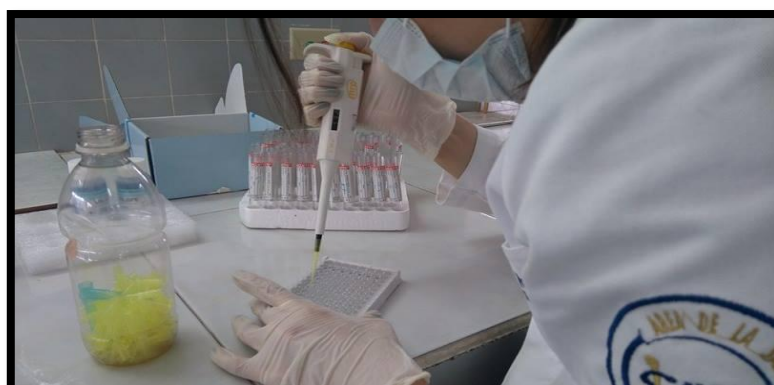
Colocar las muestras a los micropocillos para realizar el lavado, se deben hacer tres lavados
