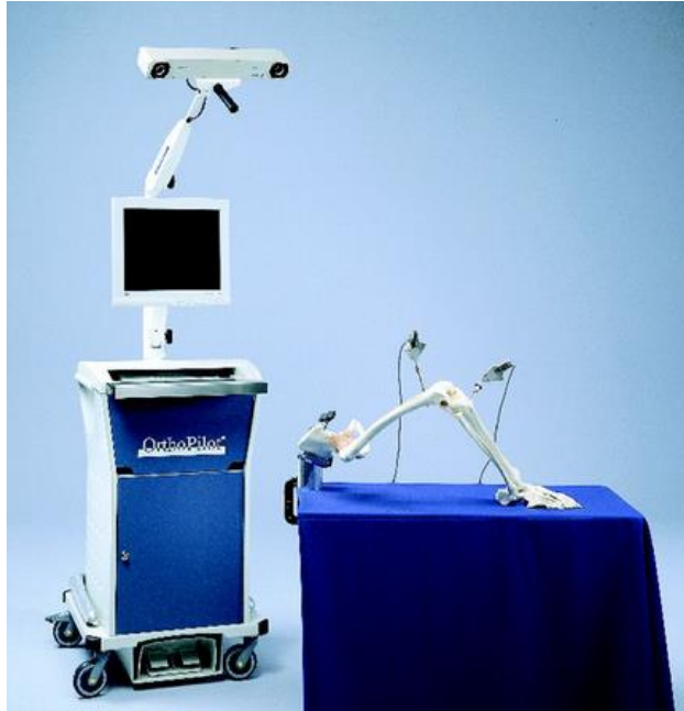
En el navegador la cámara capta los rayos infrarrojos enviados desde los emisores
