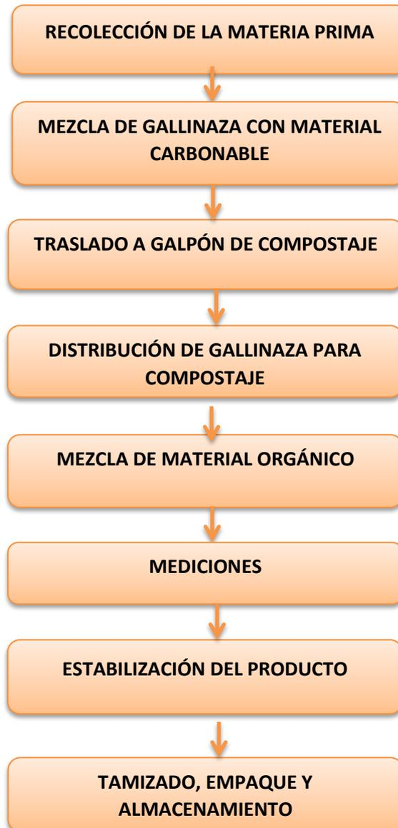
**Figura 17.** Diagrama de flujo del proceso de producción.
