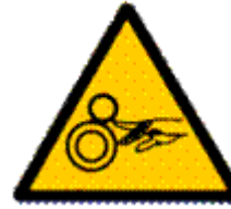
Riesgo de atrapamiento
