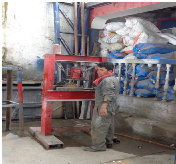
Fig. 9 Prensa hidráulica con capacidad de 30 toneladas
