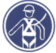
Protección obligatoria contra caídas
