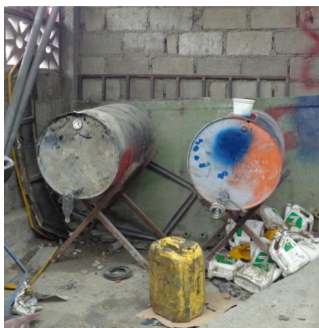
Fig. 19 Tanques de almacenamiento de resina
