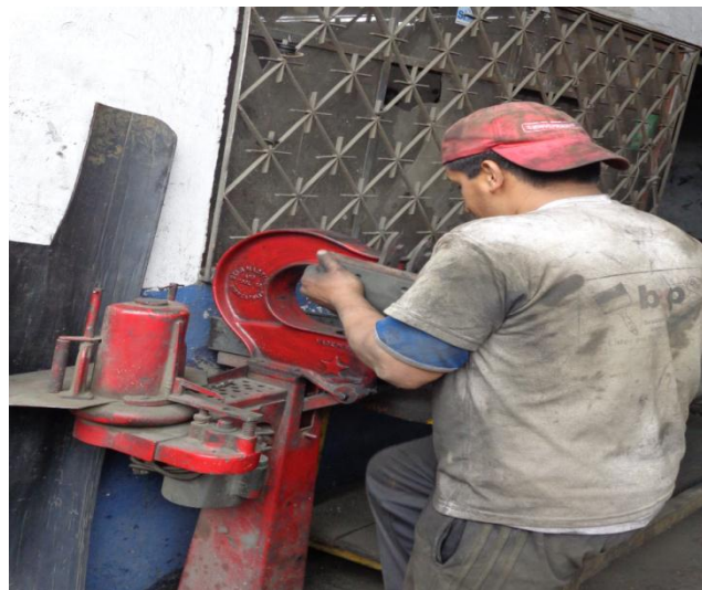
Fig. 21 Remachado de zapatas
