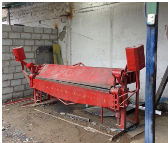
Fig. 11 Dobladora de plancha de aluminio (2.30 m longitud x 4mm espesor)
