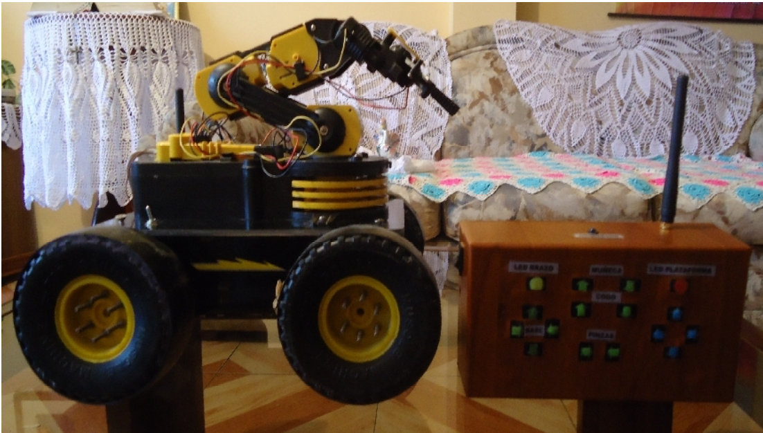
Figura Nro.-1 Brazo robótico controlado por un control joystick de forma inalámbrica, montado sobre una base móvil.
