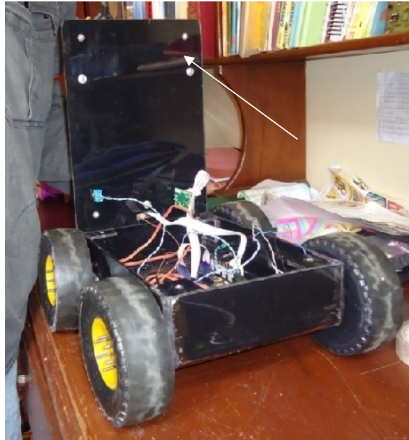
ANEXO Nro.-58 Colocación de la cubierta de la base móvil.
