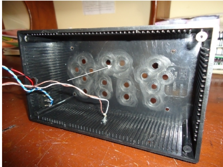
ANEXO Nro.- 60 Boquetes para los pulsadores en la palanca de control.
