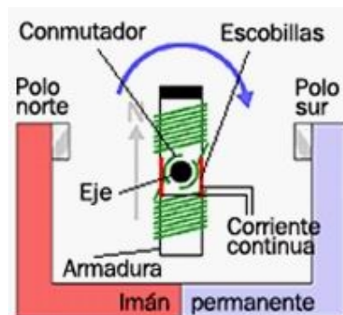
Figura Nro.-8 Estructura interna de los motores de corriente continua.
