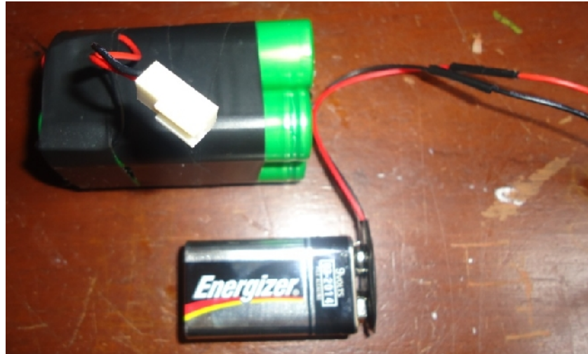
ANEXO Nro.-56 Baterías para los servomotores y para la alimentación de los circuitos.
