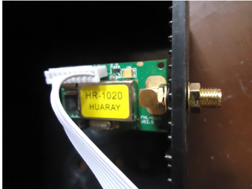
ANEXO Nro.- 64 Colocación del transceptor en la palanca de control.
