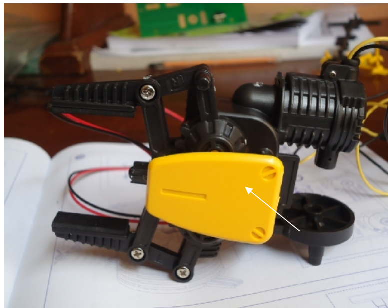
ANEXO Nro.-28 Colocación de la cubierta sobre la mano del robot.
