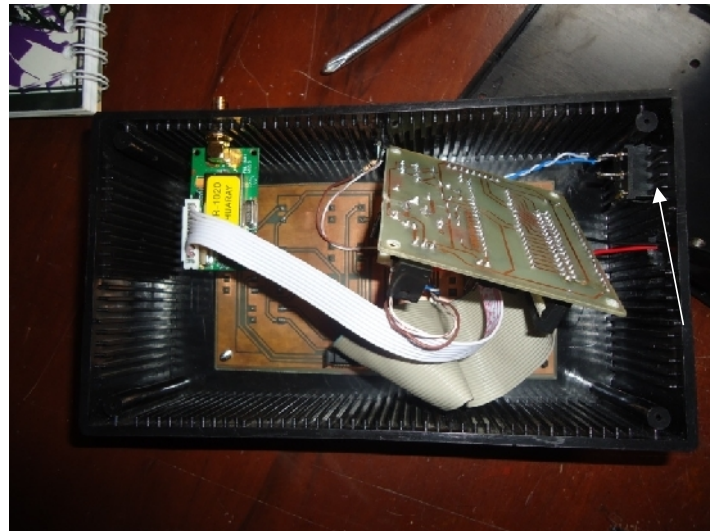
ANEXO Nro.- 71 Adición del interruptor en la palanca de control.
