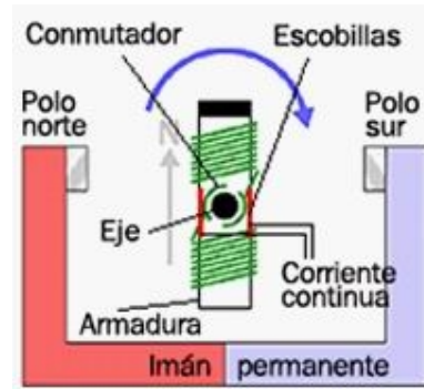
Figura Nro.-27 Estructura interna de los motores de corriente continua.
