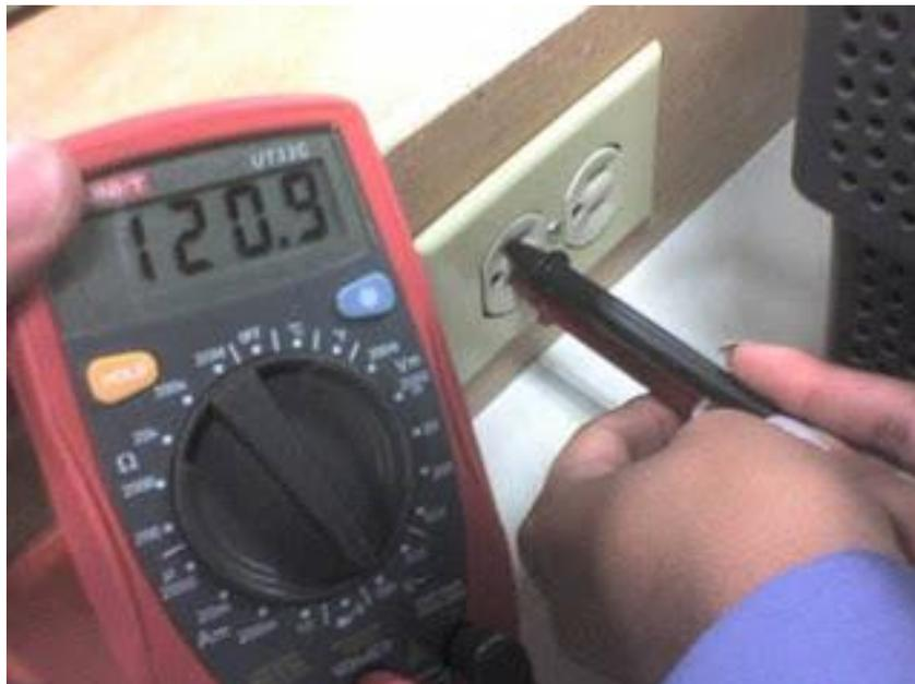
**Figura 25:** Verificación de voltajes.
