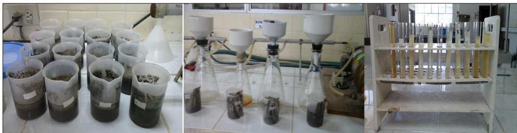
Figura 10. Análisis de la Conductividad Eléctrica en laboratorio. Elaboración: Fanny Morocho
