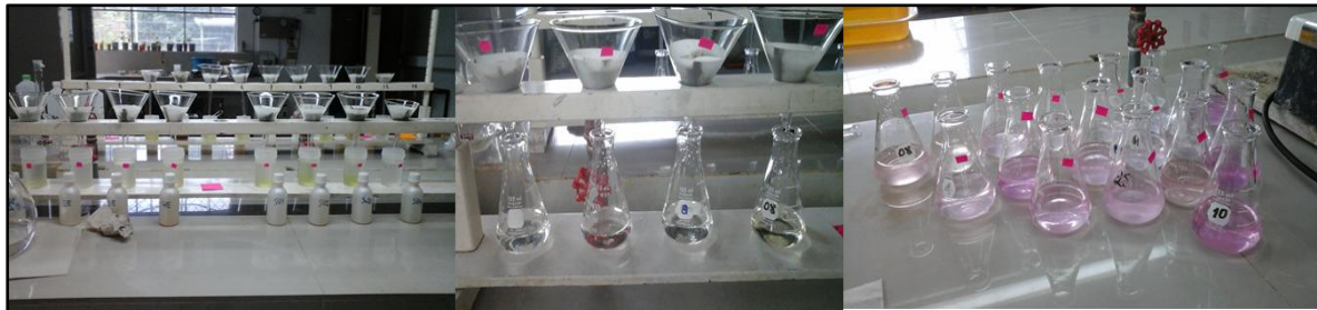
Figura 9. Análisis de Capacidad de Intercambio Catiónico en laboratorio de los tramos /SU,M,E Y C). Elaboración: Fanny Morocho
