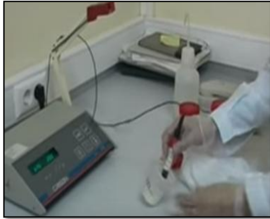
Figura 7. Medición del pH de las muestras de suelos en los tramos (SU,M,C y E).
