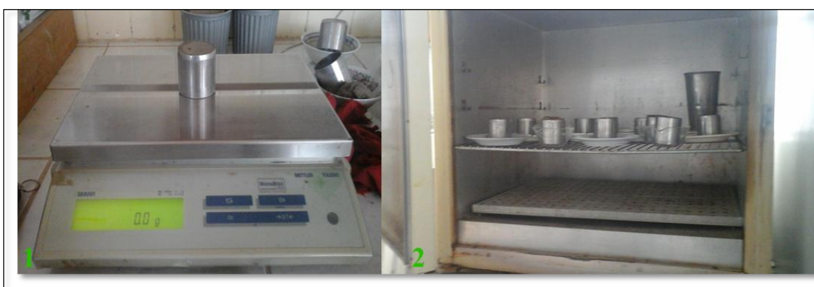
Figura 12. 1) Peso de las muestras de suelo en la Balanza digital, 2) muestras de suelo en estufa a temperatura 105°C.
