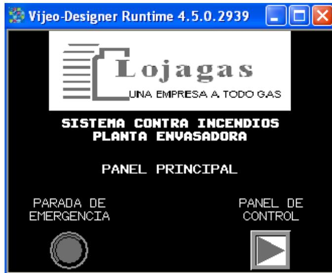
Figura 3.17 Simulación de la Aplicación en Vijeo Designer Runtime 4.5.0.2939
