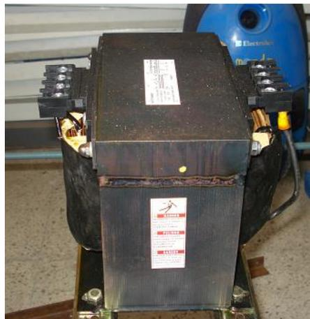
Fig. Anexo V.2. Transformador de Control
