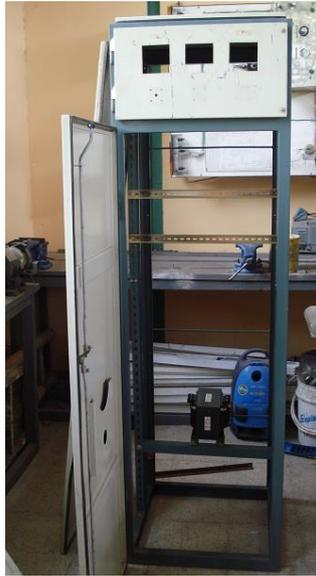
Fig. Anexo V.1. Armado Del Tablero del Sistema Contra Incendios
