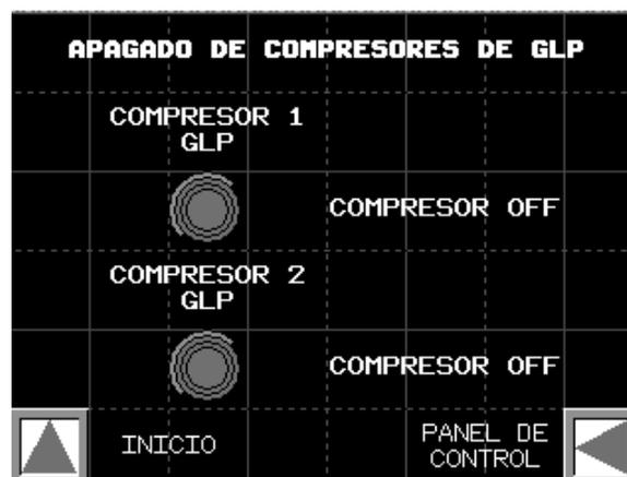
Figura 3.14 Apagado Individual de Compresores de GLP
