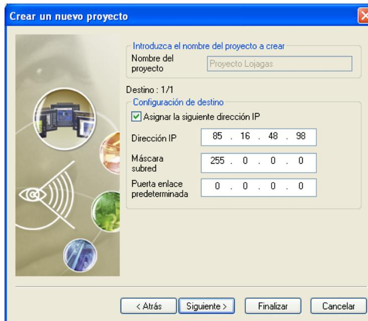
Figura 3.9 Asignación de la dirección IP al Terminal de Operador
